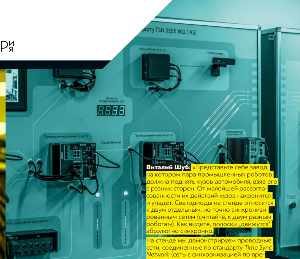
**Виталий Шуб:** «Представьте себе завод, на котором пара промышленных роботов должна поднять кузов автомобиля, взяв его с разных сторон. От малейшей рассогласованности их действий кузов накренится и упадет. Светодиоды на стенде относятся к двум отдельным, но точно синхронизированным сетям (считайте, к двум разным роботам). Как видите, полоски „движутся“ абсолютно синхронно.»
