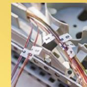
**УКЛАДКА** Освобожденные от внешней оболочки кабели заводятся в муфту. Муфта — это короб в прочном корпусе, защищающий место соединения кабелей. Для кабелей большой емкости применяются большие цилиндрические муфты с несколькими патрубками для ввода. Внутри муфты — пластмассовая платформа с кассетами. Кассеты будут хранить смотанные колечками излишки волокон. Они нужны как технологический запас на случай, если сварку нужно будет по тем или иным причинам прервать снова.
