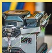
**СВАРКА** Концы волокон вытягиваются из кассет муфты и скальваются точно под углом 90 градусов. От точности скальвания зависит качество сварки, поэтому для операции применяется специальный прецизионный механизм. Мастер открывает крышку сварочного аппарата и зажимает концы волокон в каретках. Встроенные видеокamеры демонстрируют нити на дисплее с большим увеличением, помогая разместить их точно напротив друг друга. Затем подается дуговой разряд.
