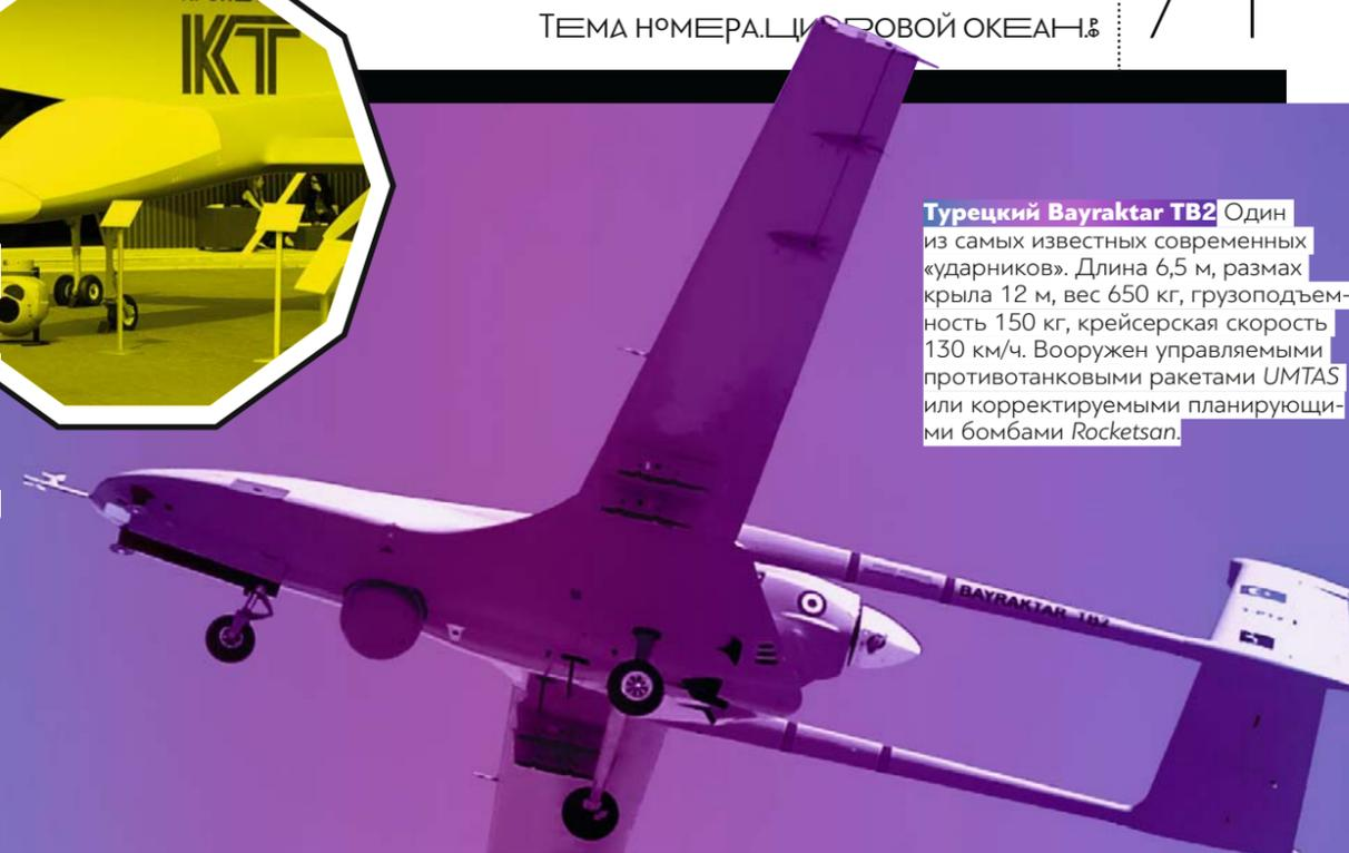
**Турецкий Bayraktar TB2** Один из самых известных современных «ударников». Длина 6,5 м, размах крыла 12 м, вес 650 кг, грузоподъемность 150 кг, крейсерская скорость 130 км/ч. Вооружен управляемыми противотанковыми ракетами UMTAS или корректируемыми планирующими бомбами Rocketsan.
