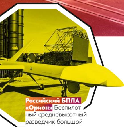
**Российский БПЛА «Орион»** Беспилотный средневысотный разведчик большой продолжительности полета, предназначенный для оптико-электронной, радиолокационной и радиотехнической разведки, целеуказания и корректировки огня. Полезная нагрузка (включая возможность нести управляемую авиационную бомбу) — 180 кг. Длина 8 м, размах крыльев 16,3 м, взлетный вес 1000 кг. Двигатель турбовинтовой, с толкающим винтом. Крейсерская скорость 120–200 км/ч, продолжительность полета 24 ч.
